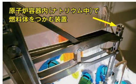
(写真2) 原子炉容器内で燃料体を取り扱う設備の事前点検
